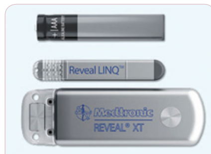
Obr. 6. Príklady implantovateľných EKG monitorovacích prístrojov – Reveal XT ® a Reveal Linq ® , výroby firmy Medtronic, USA. Veľkosť v porovnaní so štandardnou tzv. tužkovou batériou typu AA (obrázok je upravený – originál získaný z webovej stránky výrobcu).
