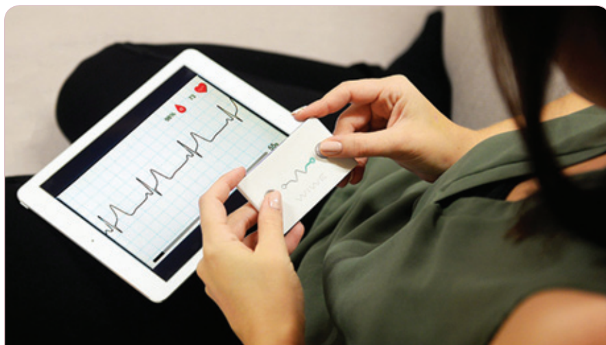
Obr. 5. Ďalší príklad tzv. nalepovacieho EKG záznamníka kombinovaného s vyšetrením saturácie periférnej krvi O_2 – Wiwe (foto Orin, Maďarsko).
